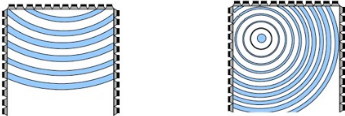
Εικόνα 15: Συστοιχία ηχείων σε γραμμική διάταξη (line array) και στις τρεις πλευρές ενός τετραγώνου. Φαίνονται τα μέτωπα των εικόνων που θα δημιουργήσουν οι ηχητικές πηγές. Αριστερά είναι μια συντεθειμένη ηχητική πηγή εκτός των ορίων της διάταξης των ηχείων ενώ δεξιά η ηχητική πηγή είναι εντός.
