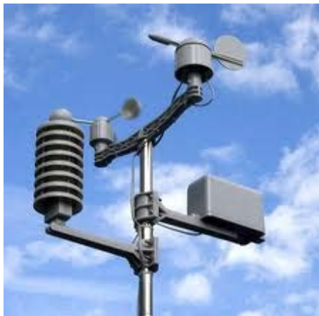
Σχήμα 1 Αυτόματος Μετεωρολογικός Σταθμός σε λειτουργία
